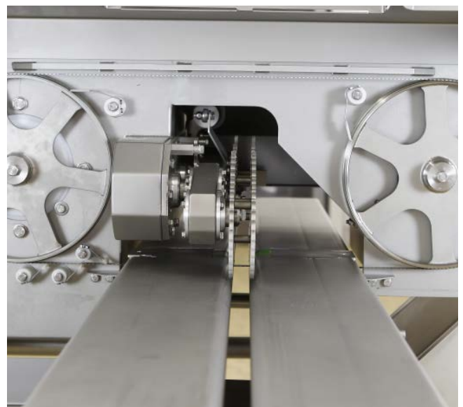
Geöffnete Maschine mit horizontaler Bandsäge
